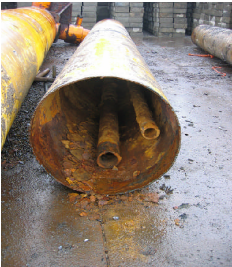
Foto 17: besmet onderdeel van gaswinningsplatform met losliggende scale
