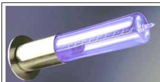
Fig. 24 Xenon gevulde Deep UV (DUV) excimerlamp met een golflengte van 172 nm (20W elektrisch vermogen in, 8W DUV uit) Er zijn verschillende vulgassen mogelijk.
