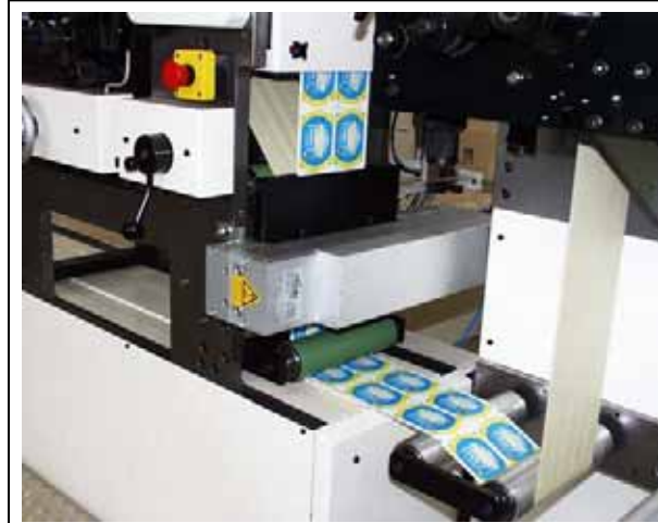
Fig. 32 Toepassing van UV-uithardende drukinkt (Hogedruk kwiklamp met UVA doorlaatfilter) Let op de gele waarschuwingssticker voor monteurs foto Sadechaf UV-Techniek België
