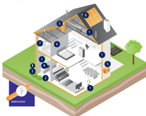
Figuur 9a. Waar in de woning zijn er maatregelen nodig om de woning aardgasvrij te verwarmen. Deze afbeelding is met warmtepomp. Bij een warmtenet wordt 5 voor vervangen door een afleverset.
