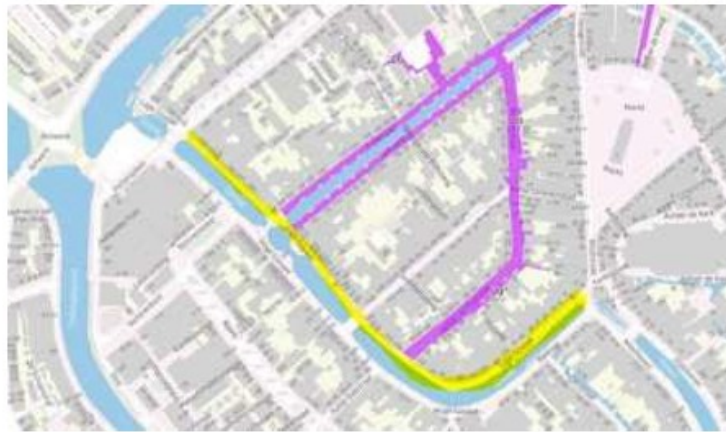
Figuur 4: in geel de Lage Gouwe waar parkeren wordt opgeven en een gewichtsbepierking nodig is om de belasting van de kademuur te verminderen (en daarmee het risico op instorten)
