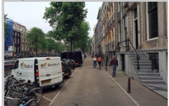
Herengracht, Amsterdam (rijbaan 3,85 m en totaal 9,6m)
