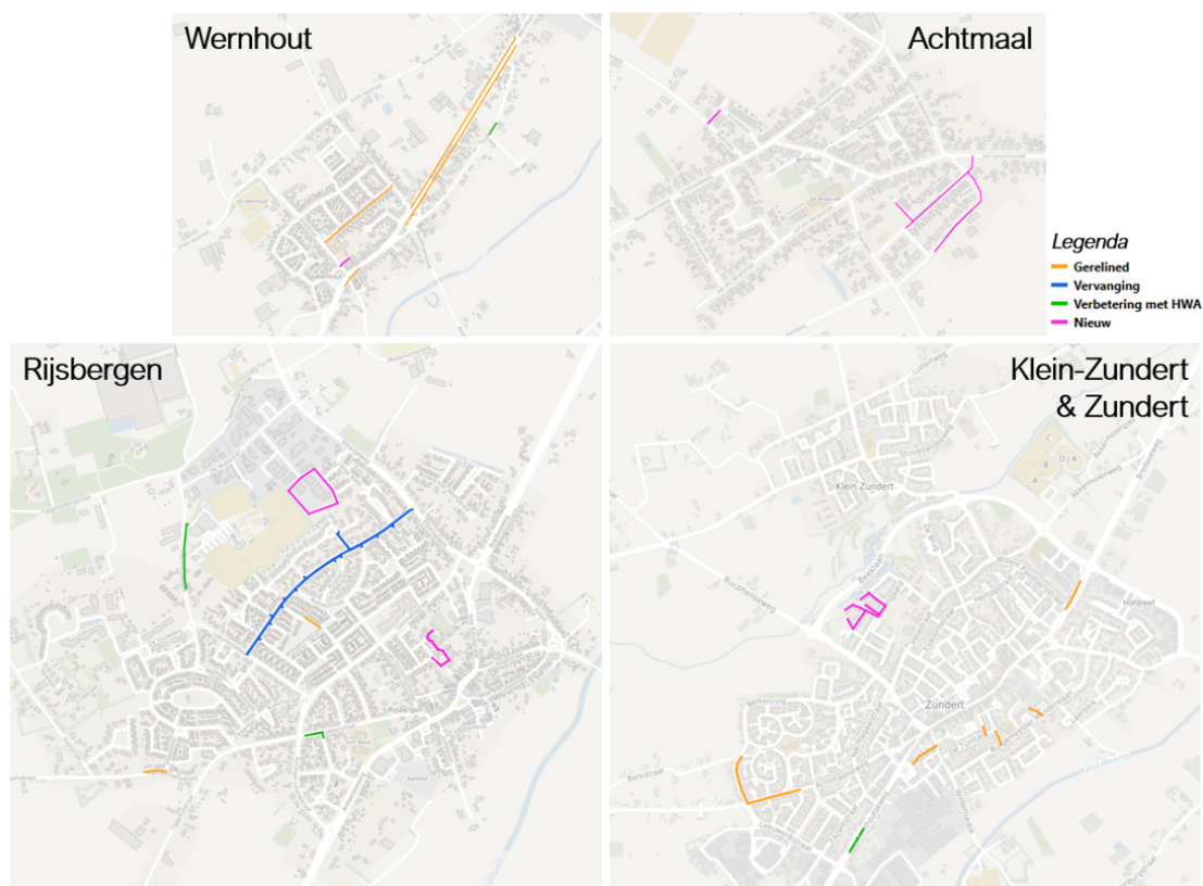
Figuur 2.2 Vervangen, gerelinede en nieuw aangelegde riolering
