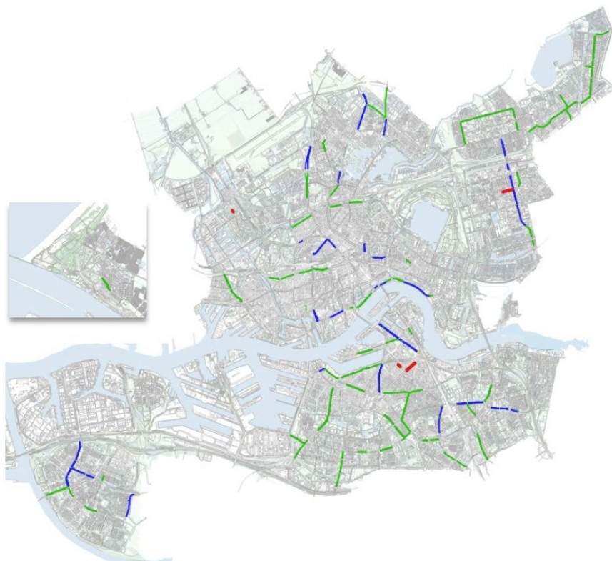
Figuur 3 - Stil asfalt in Rotterdam (blauw is aangelegd in de periode 2019-2023 en groen in de periode ervoor, rood zijn de pilots met stille klinkers)
