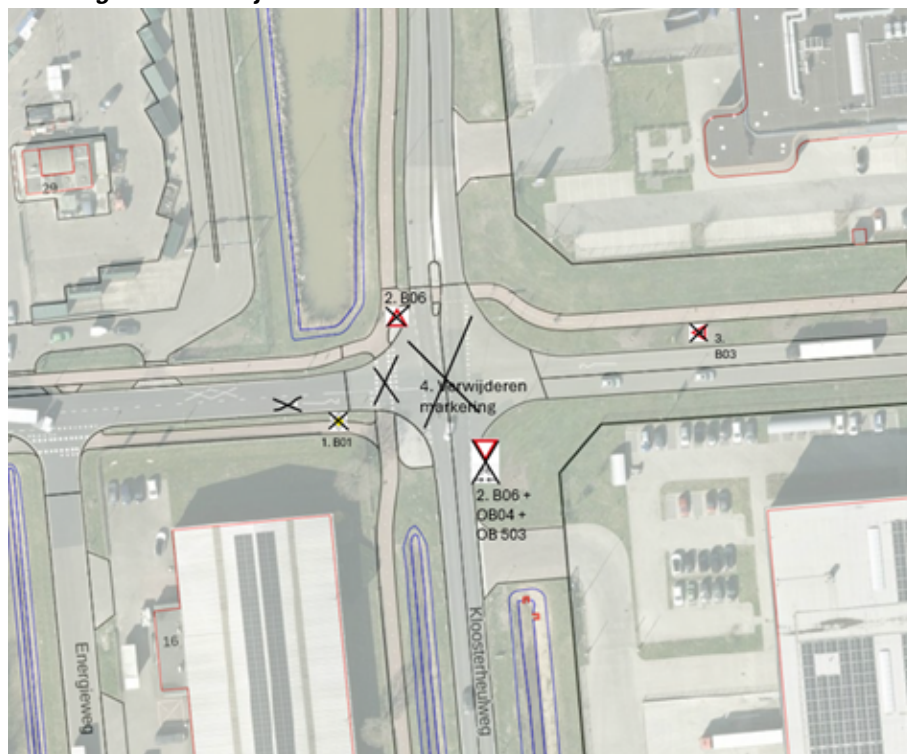
Tekening 1: Het verwijderen van de oude situatie
