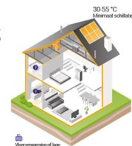
Vloerverwarming of lage temperatuur radiatoren
