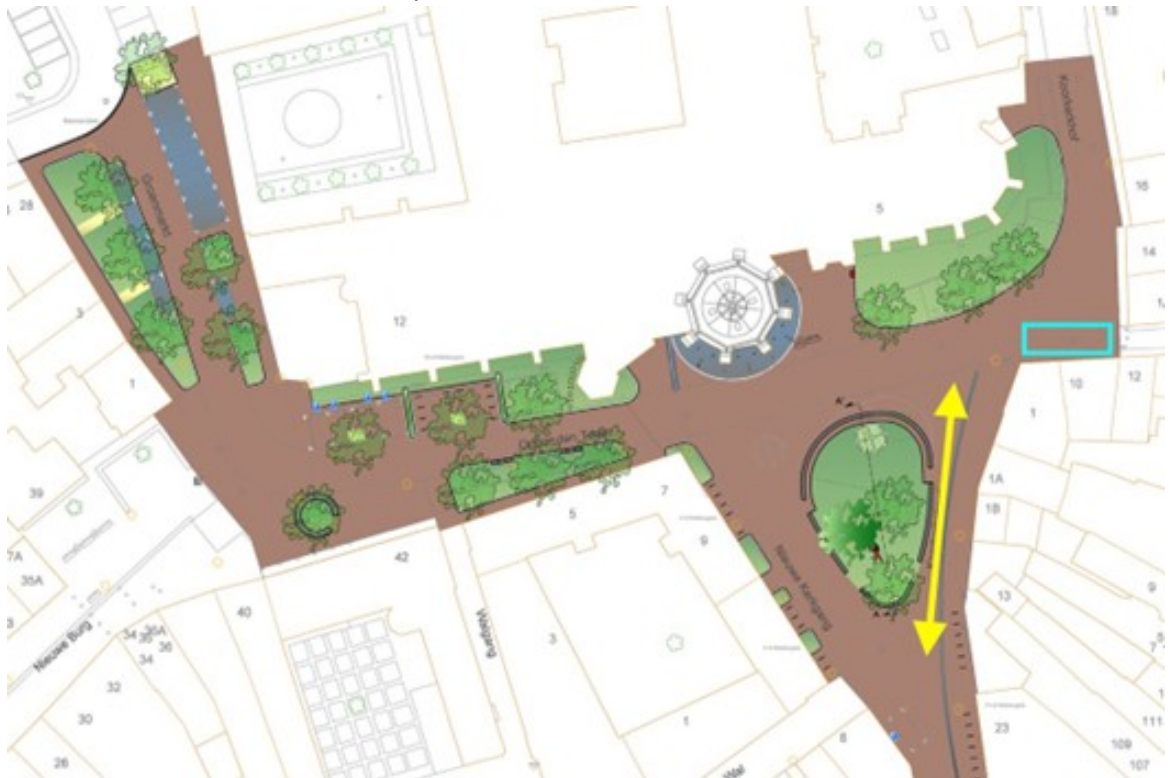
Plantekening met aanduiding van voorgestelde voetgangersstrook en laad/losplaats.
