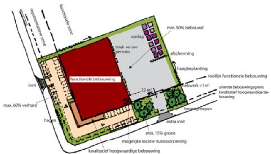
Figuur 6.3 Principeoplossing rooilijn en kavel, hoekkavels
