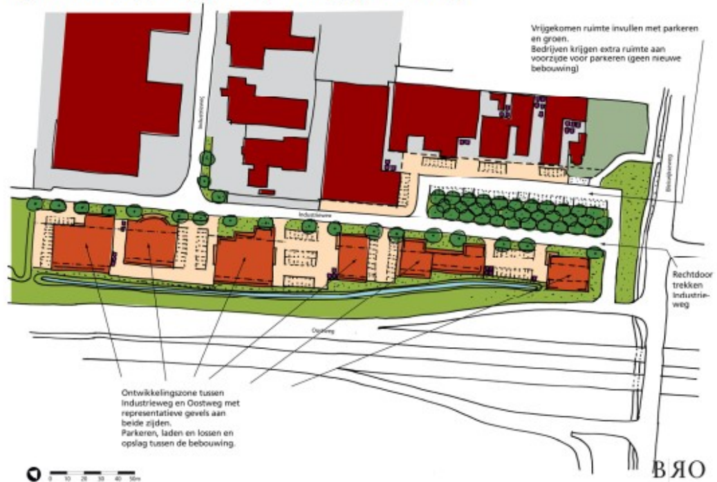
Figuur 6.5 Principeoplossing gedeeltelijke verlegging Industrierweg
