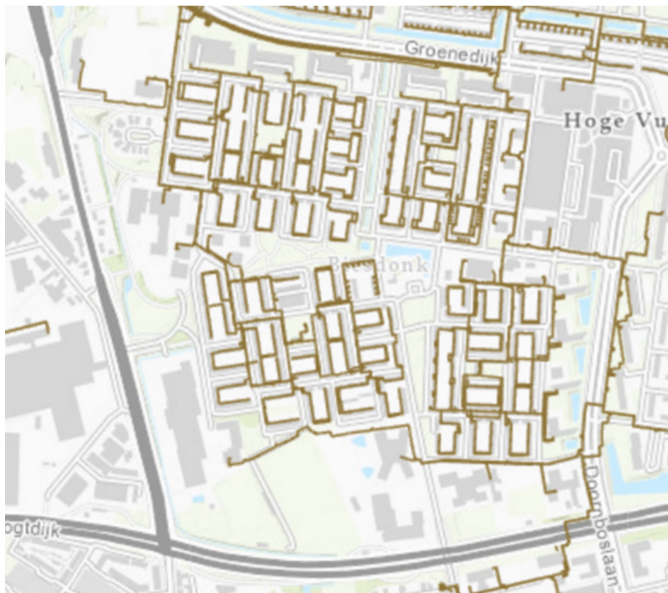
Afbeelding 3.11 Infrastructuur stadsverwarming Biesdonk (bron: Geoweb )
