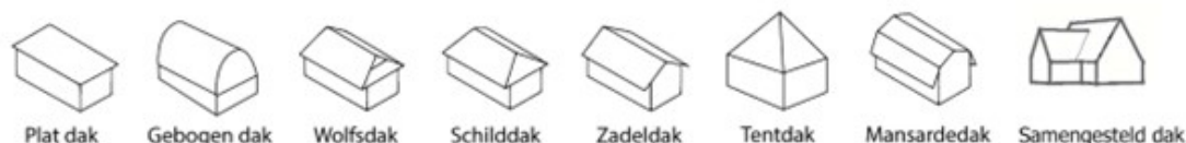
Afbeelding 1 : verschillende dak- of kaptypes
