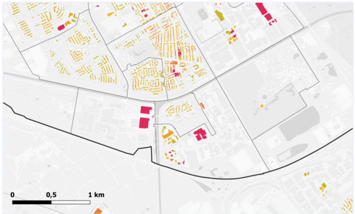
Figuur 5.1b: warmtedichtheidsanalyse Best. Gebruikte referentiestraal van 50 meter op pandniveau. Waar woningen (donkerder) inkleuren is er meer potentie voor een (kleinschalig) warmtenet.
