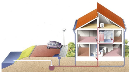
Figuur 4-1 Gemengd rioolstelsel
