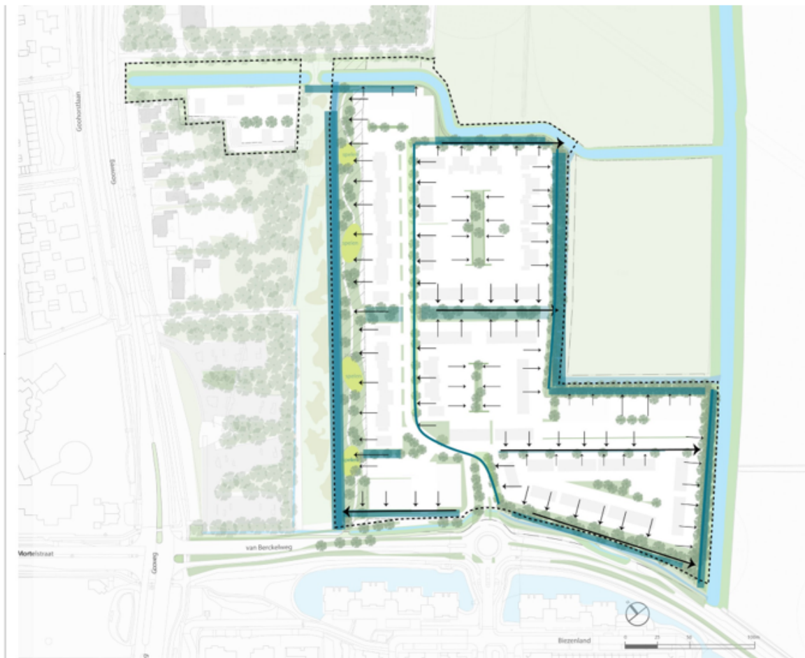
Slim gebruik maken van compacte woonstraten door open waterafvoer en waterdoorlatende bestrating
