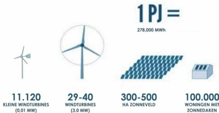
Figuur 7.3: Energieopbrengst van hernieuwbare energiebronnen: KWT in verhouding met grote turbines en zonnepanelen
