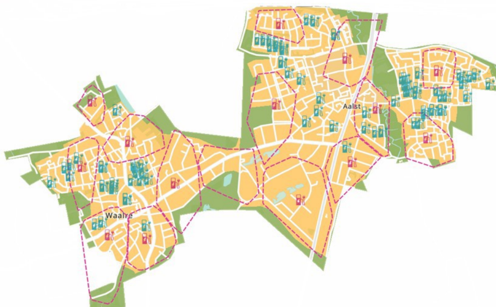
Figuur 11 Stap 5: Evenwichtige spreiding door toevoeging van laadpaallocatie op basis van clustering en woningdichtheid. De rode laadpaallocaties zijn op basis van woningdichtheid inclusief woningen met eigen oprit, de groene laadpalen zijn op basis van modelberekeningen.
