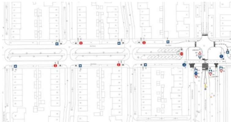
verkeersborden te plaatsen Eli Heimanslaan - Sportlaan deel oost
