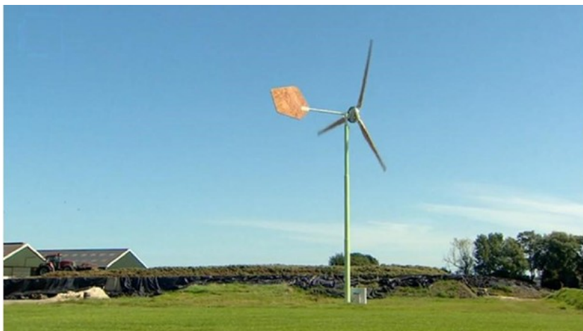
Figuur 1: Een kleine windturbine waarvan de as horizontaal is georiënteerd (HAT-turbine).
