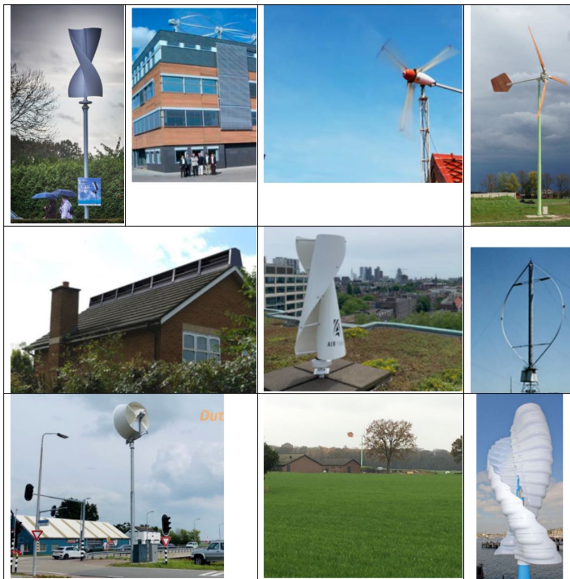
Figuur 3: varianten HAT en VAT molens
