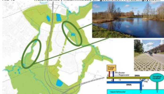
Afb 18 Waterretentie , Waterinfiltratie en gescheiden Afwateringsysteem
