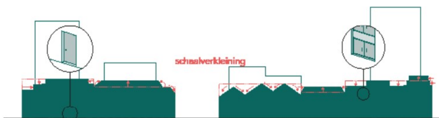
Schaalverkleining in de gevel door middel van detaillering, verkleiningen van bouwmassa's, setbacks, erkers en dergelijke
