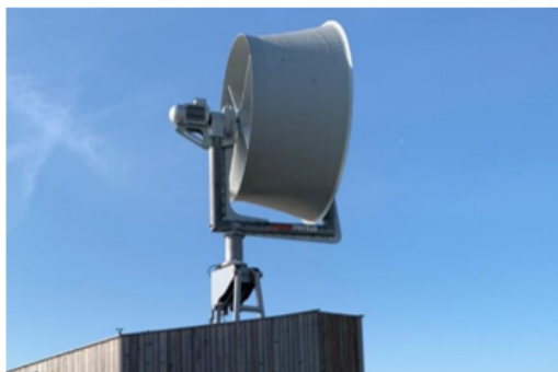
Figuur 2.5: DutchVentus windturbine op daken te plaatsen. Deze heeft een diameter van 3,5 m en een vermogen van 10 kW (0,01MW), opbrengst van 18 MWh/ jaar, Bron: nwea.nl
