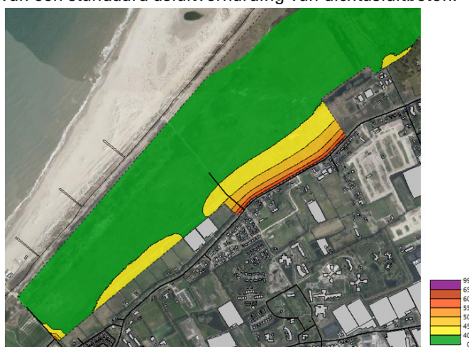
Figuur 6.1: Geluidsbelasting stiltegebied na toepassing geluidsreducerend wegdek (waarneemhoogte 4 meter)
