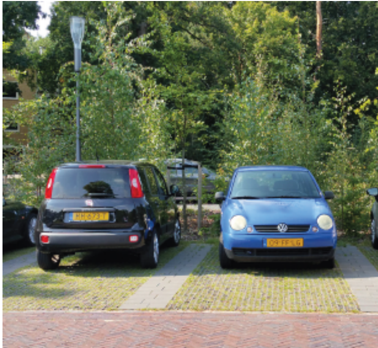
Parkeren in grasbetonstenen. Ondergronds kunnen infiltratiekratten worden toegepast indien nodig
