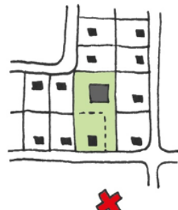
Verkeerde korrelgrootte van de bebouwing
