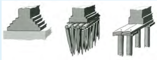
Fundering op staal met verbrede funderingsvoet
