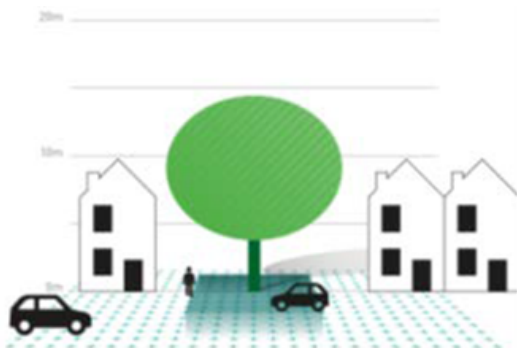
Principedoorsnede van de ruimte die een boom nodig heeft. Bron: Norminstituut Bomen
