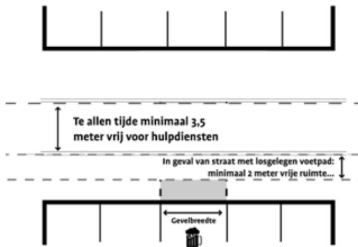
Figuur 4: principetekening gevelterras; separaat voetpad van minimaal 2 meter.
