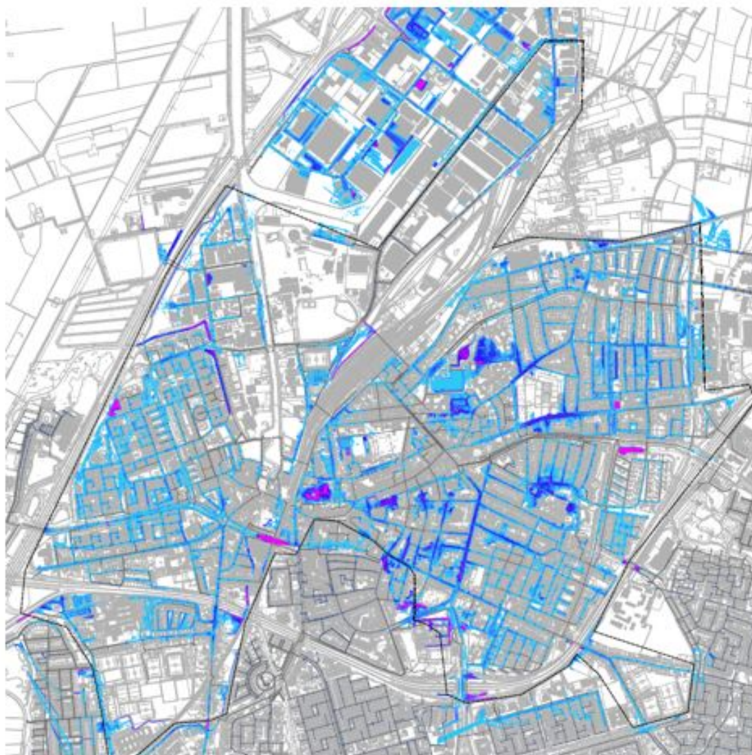
Figuur 3 Berekende wateroverlast bij de bui Herwijnen (2011, 94 mm neerslag in 70 minuten)
