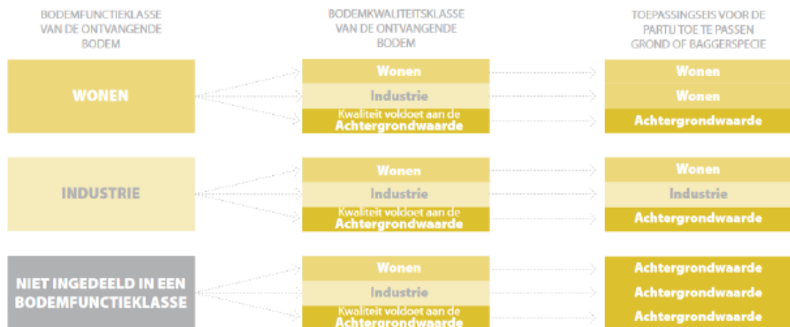
Figuur B1.1 Werking dubbele toets in het generieke kader. Bron: Handreiking besluit bodemkwaliteit via
