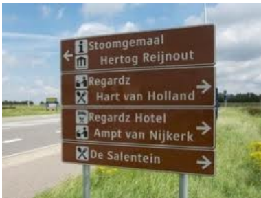
Figuur 3. voorbeeld van groot model strokenbord op 2 flespalen buiten de bebouwde kom
