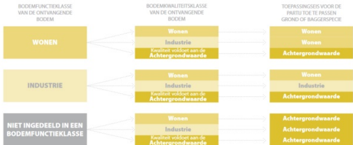
Figuur B1.1 Werking dubbele toets in het generieke kader. Bron: Handreiking besluit bodemkwaliteit via https://www.bodemplus.nl/onderwerpen/wet-regelgeving/bbk/instrumenten/handreiking-bbk/
