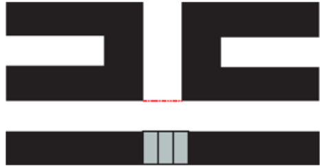
Afbeelding: referentielijn zichtbaarheidsregel bij T-splitsing
