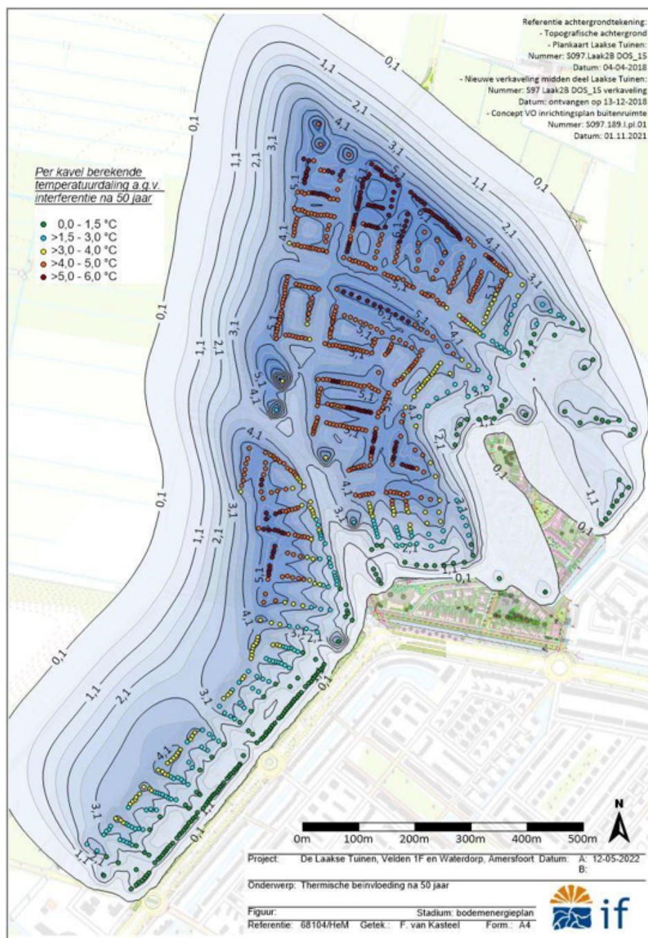
Figuur 3.1 | Thermische beïnvloeding tussen 0 en 280 m-mv na 50 jaar (zie ook Bijlage 1 voor groot formaat)
