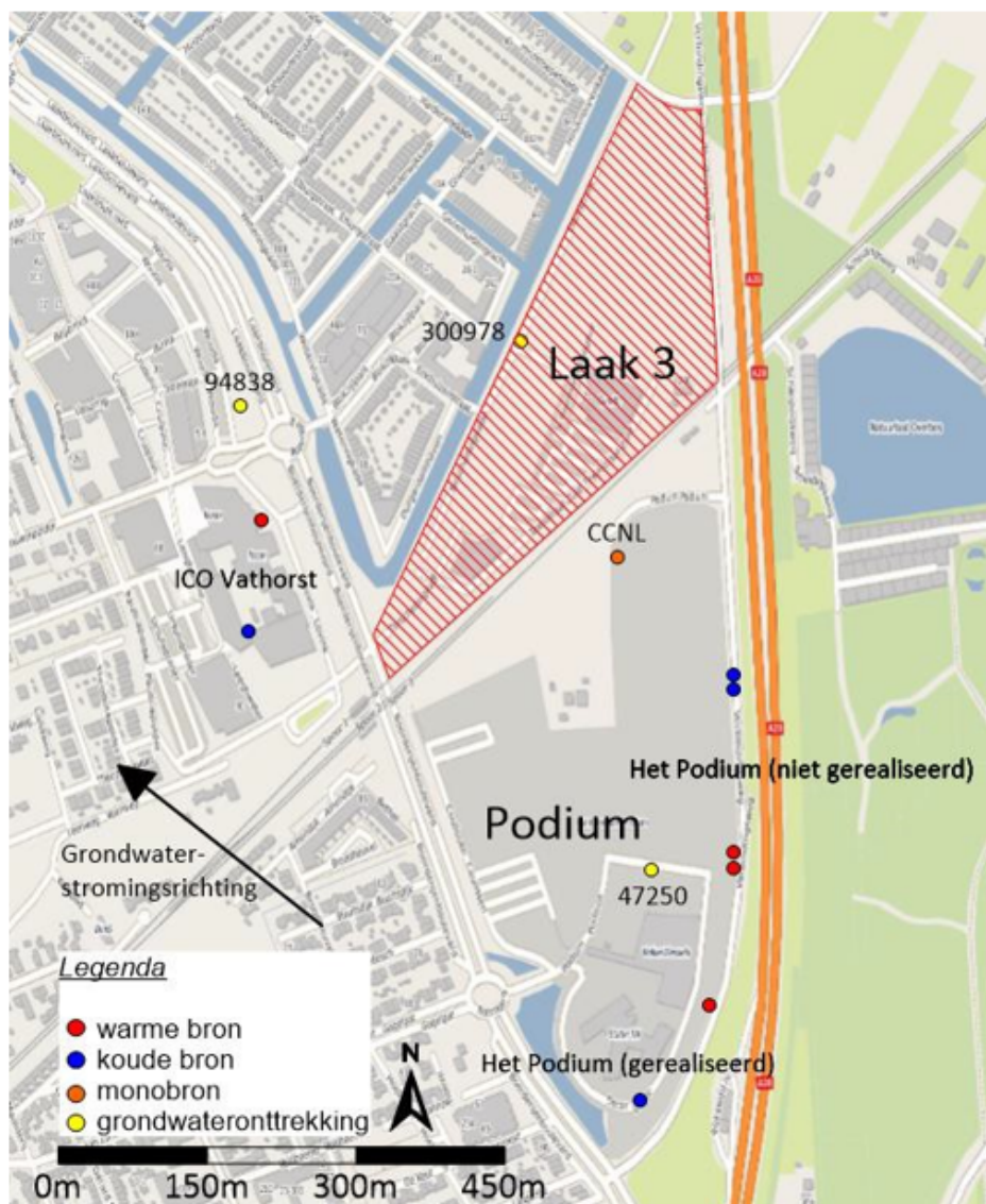
Figuur 2.2 | Omringende open bodemenergiesystemen en grondwateronttrekkingen
