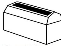
Bij mansardedaken worden panelen op het hoogste dakdeel geplaatst.
