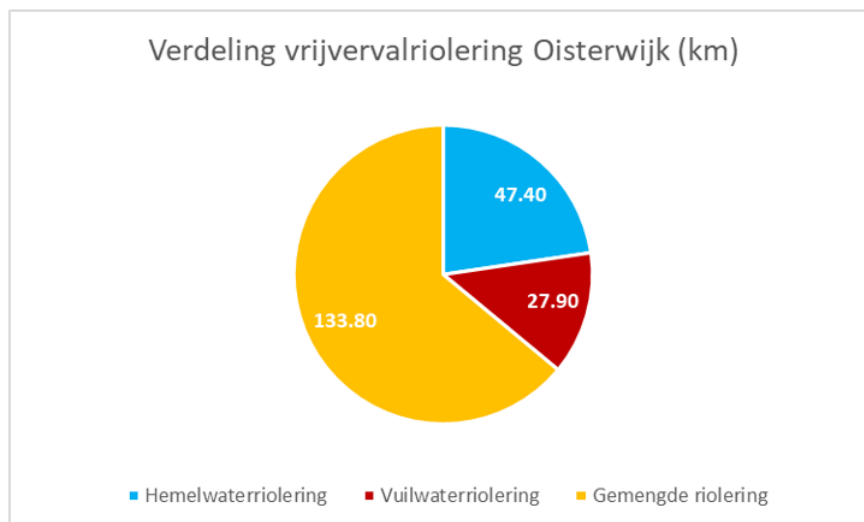
Figuur 1: Riolering in gemeente Oosterwijk
