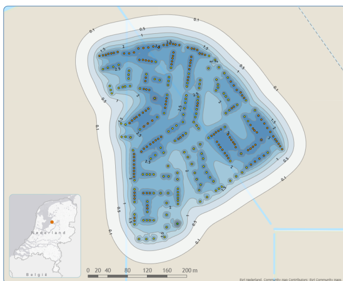
Figuur 3.1 | Thermische beïnvloeding tussen 0 en 225 m-mv na 25 jaar (zie ook Bijlage 1 voor groot formaat)
