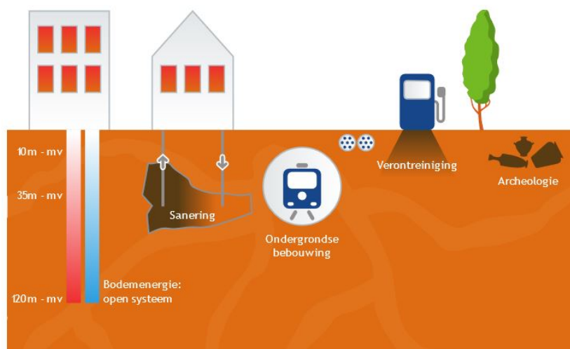
Figuur 1.2 | Overzicht ondergrondse functies
