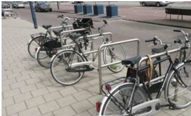
Figuur 4: De zogenaamde nietjes zijn een geschikte oplossing voor brede stoepen.
