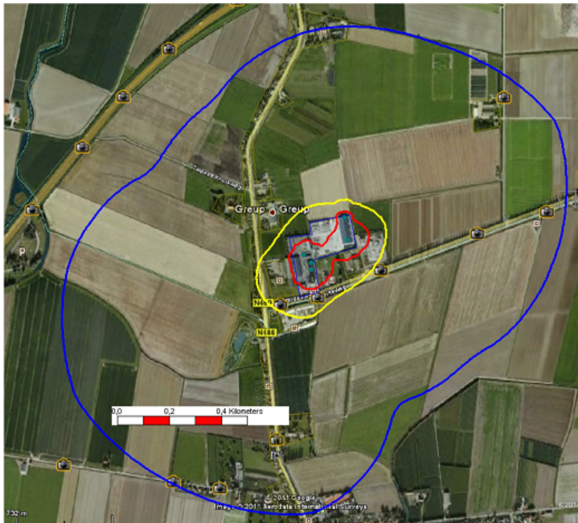
Figuur 2: Voorbeeld contouren van plaatsgebonden risico (PR) waarbij de rode de 10-6/jaar voorstelt
