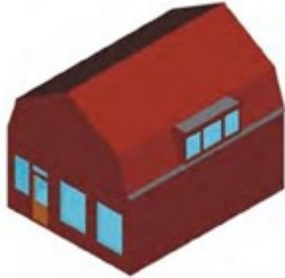
Op mansardekap in onderste dakvlak plaatsen en aansluiten op knik
