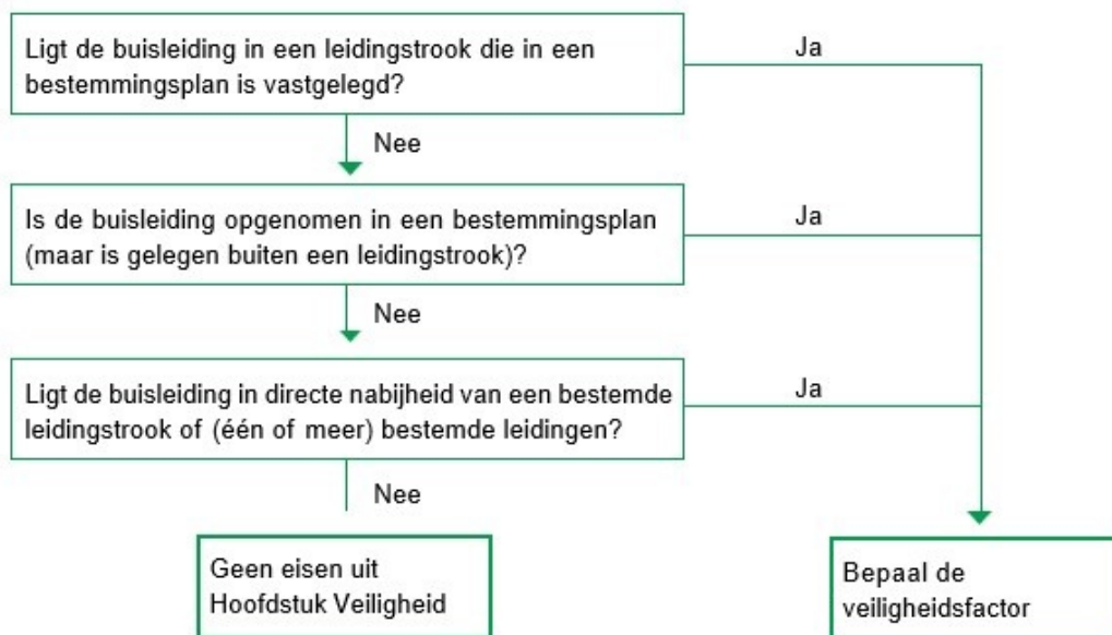
Figuur 3, Schema bepaling veiligheidsfactor
