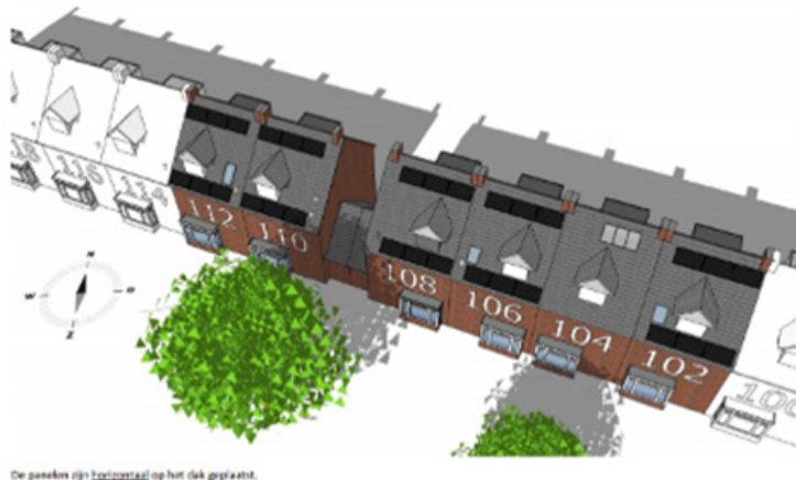
De panelen zijn horizontaal op het dak geplaatst.
