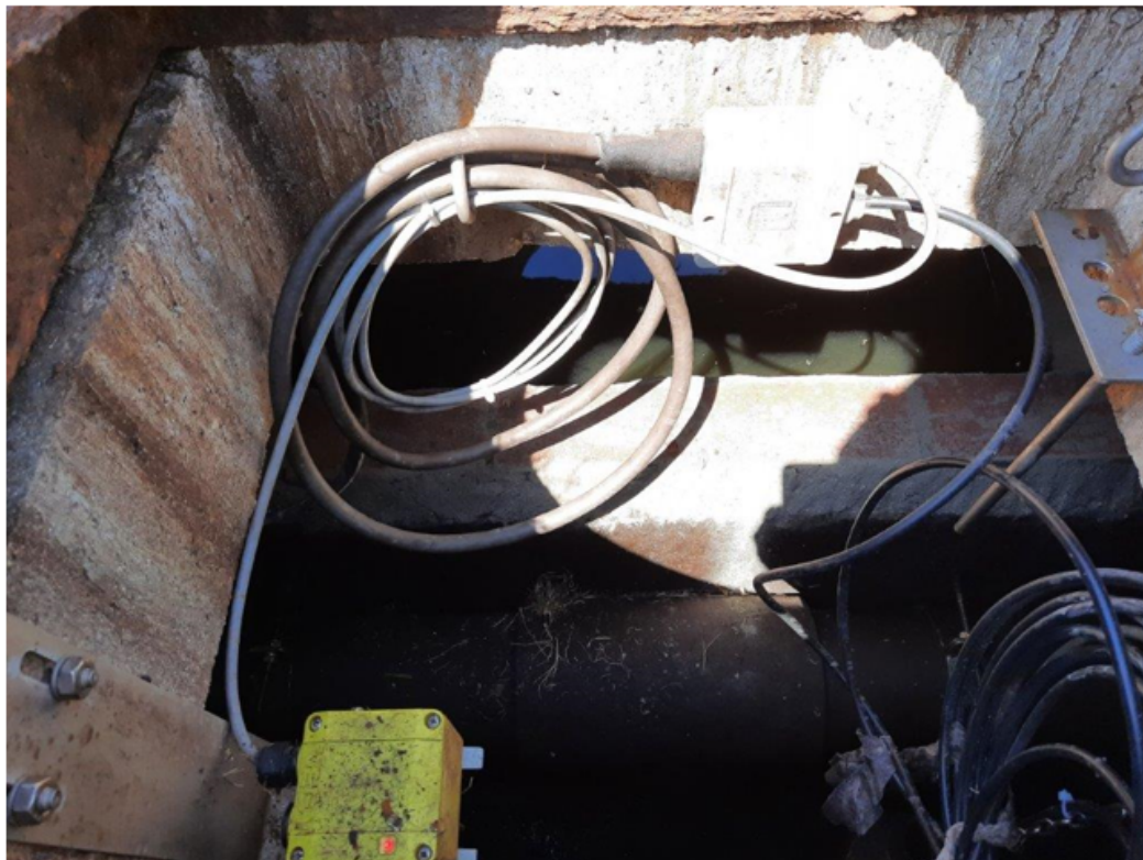
Figuur 8: Door waterniveaus te meten krijgen we inzicht in het ledigings- en vullingsgedrag van de riolering
