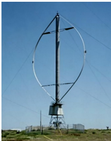
Windturbine van het zgn 'Darrieus -type'
