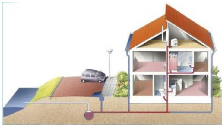
afbeelding 7 gemengde riolering (bron: Paul Maas, Tilburg / stichting RIONED)
