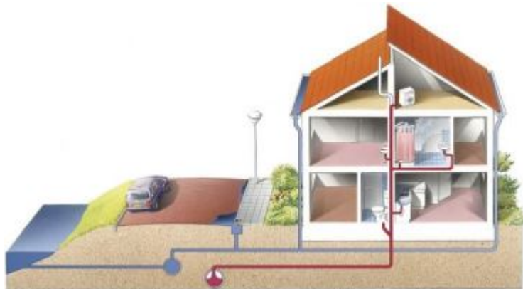
afbeelding 8 gescheiden riolering (bron: Paul Maas, Tilburg / stichting RIONED)
