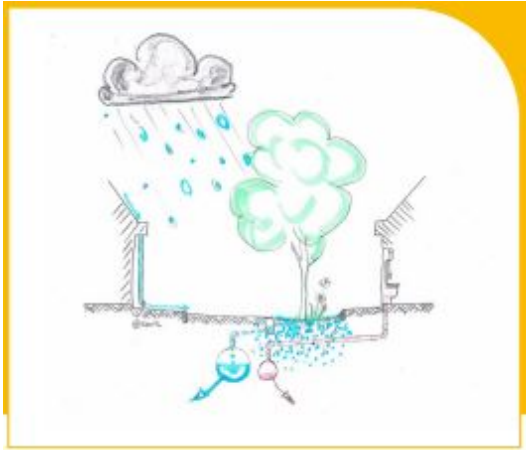
Principe-doorsnede straatprofiel met gescheiden rioolsysteem
