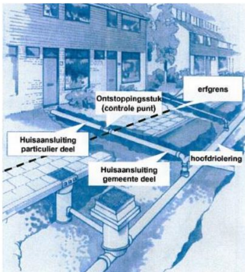
figuur 8: Principesituatie aansluiting woning op gemeentelijk riool
