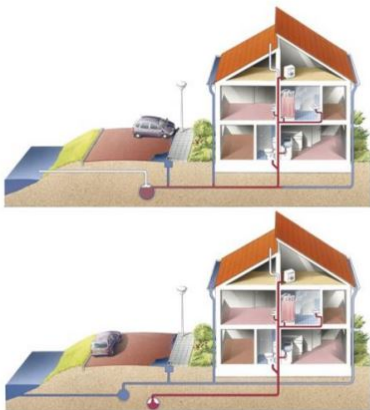
figuur 7: Boven: gemengde riolering. Onder: gescheiden riolering
