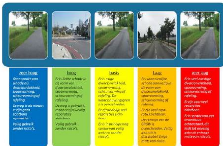
Figuur 4 Voorbeeld meetlat: een niveau, een norm en een beeld
